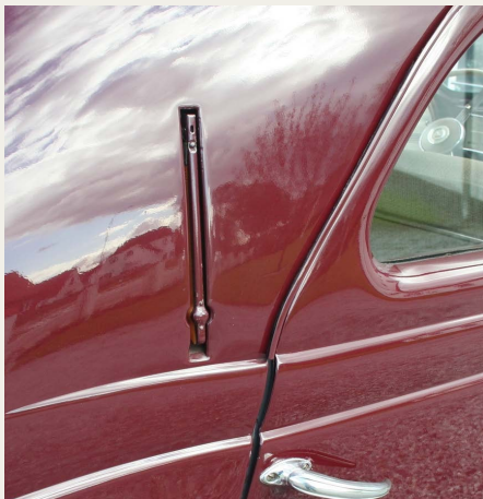
Retningsviserarmen er indføjet i karrossen, ikke som de fleste mellem for og bagdør, men bag bagdøren.
