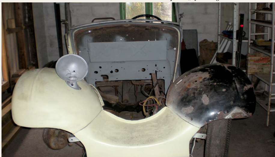
Genopbygning af front og forskærme
