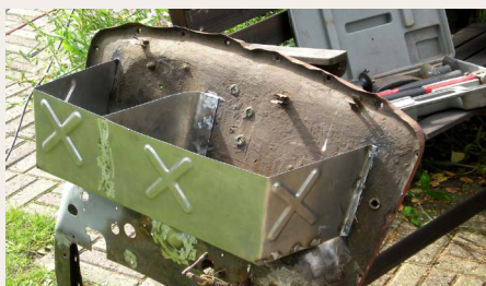
Konstruktion af ny batterikasse
