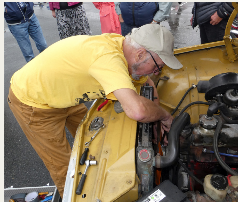
Per Jørgensen i gang med at afmontere den defekte generator, inden regnen gjorde nødvendigt med en lille bær af paraplyer.
