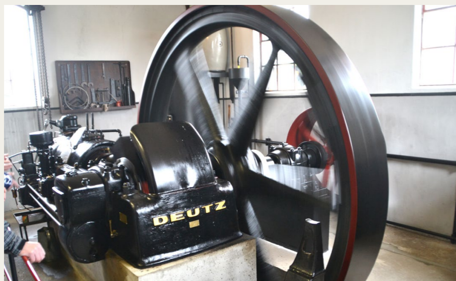
En af Dansk Motorsamlings perler er denne imponerende vandretliggende én-cylindret dieselmotor, som har et slagvolumen på hele 67.000 ccm. Motoren, som yder 80 hk, har fra ny i 1930 trukket et el-anlæg under Aalborg El-forsyning. Senere har den trukket et savværk i nærheden af Ebeltoft.
