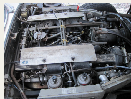
Den store V12 motor fylder godt i maskinrummet.
